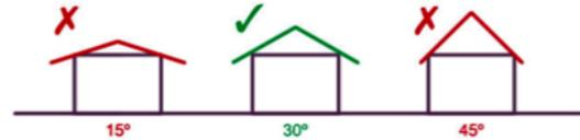
Para reducir los efectos de succión y desprendimiento cuando hay fuertes vientos, trate de construir su techo con un mínimo de 30 grados de inclinación y un máximo de 40 grados.
