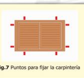
Fig.7 Puntos para fijar la carpintería
