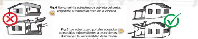
Fig.4 Nunca unir la estructura de cubierta del portal, colgadizos o terrazas al resto de la vivienda
